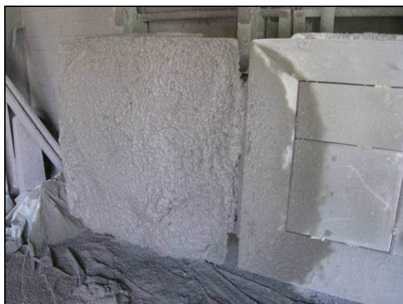
BILD 1b. En form fylld med sprutad betong.
